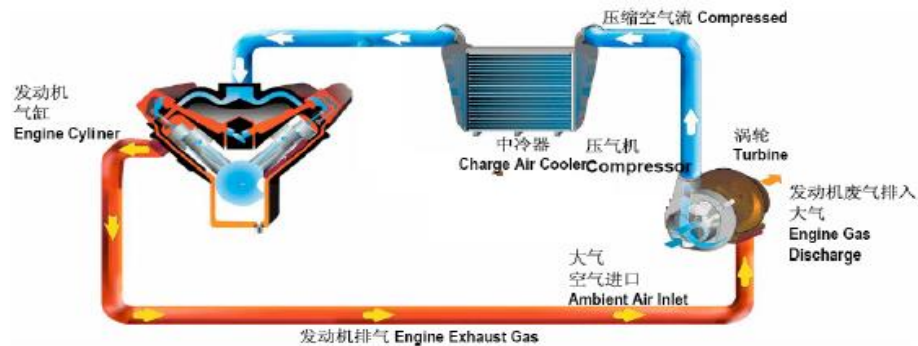
Принципиальная схема работы турбокомпрессорного двигателя
